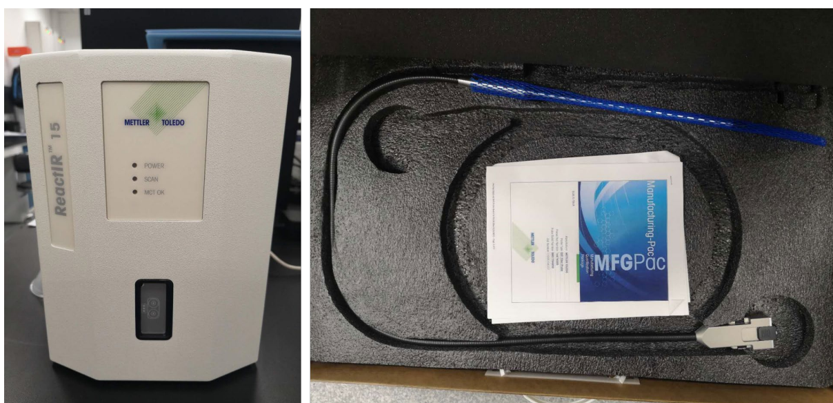
图 4-1 REACTIR 15 原位红外光谱仪的主机 (左) 和探头 (右)
