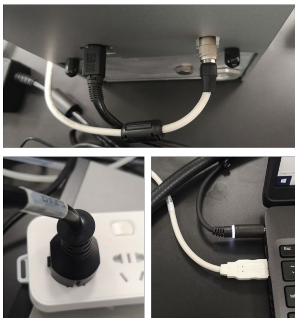
图 4-3 主机电源线和 USB 线的连接
