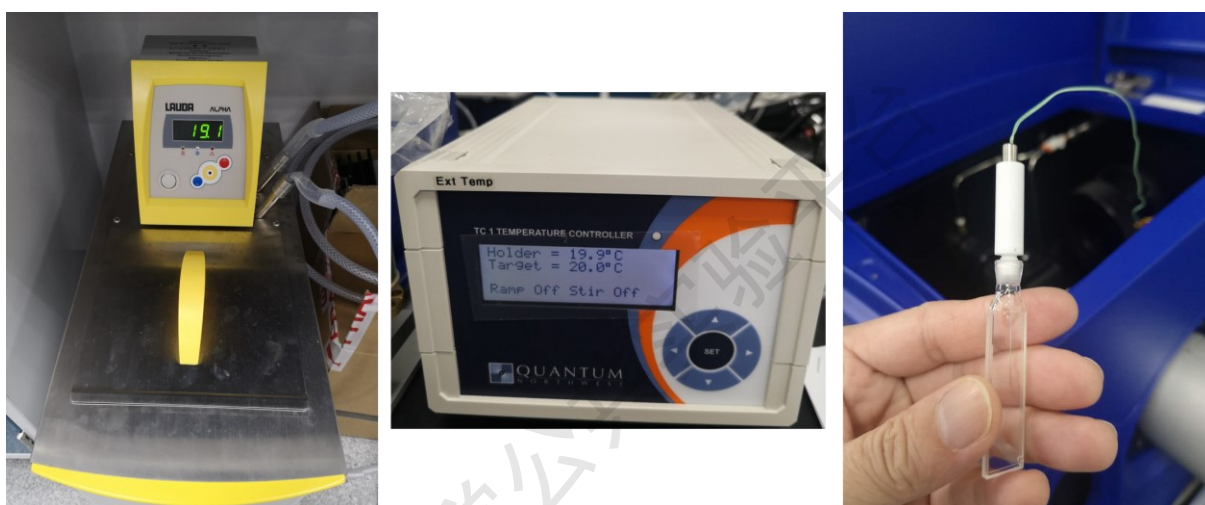
图 6-20 循环装置（左）、温控仪（中）、针式温度计（右）照片
