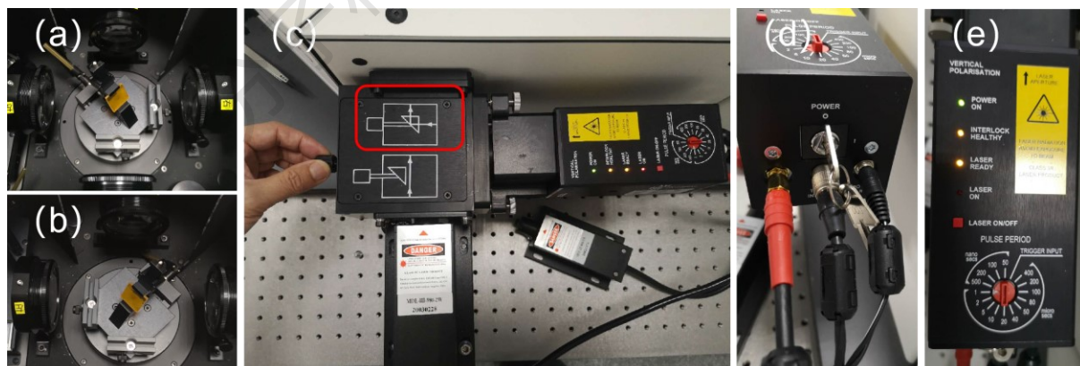
图 6-24 EPL 激光器的发射光路(a 和 b)，入射光路选择(c)和激光器连接(d)
