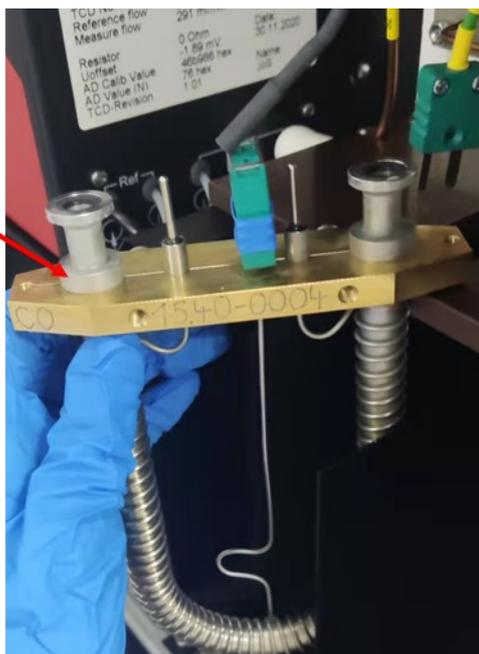
1: 用夹子与88号管将CO吸附柱前部孔与吸收管上口连接
