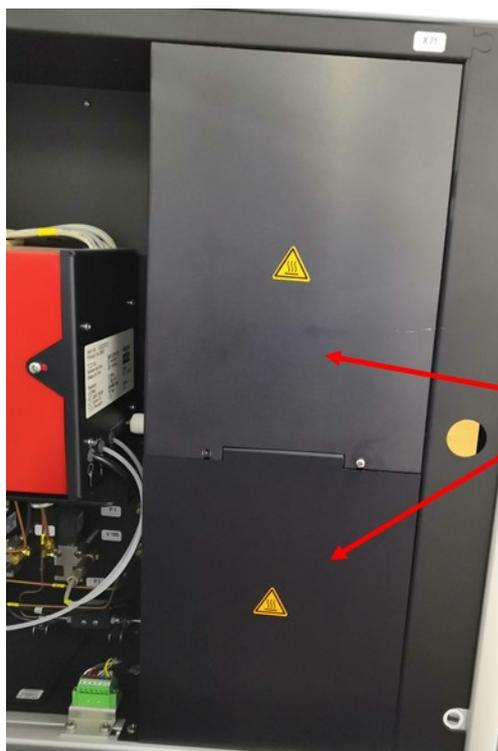
拆除仪器左侧的两块隔热保护板
