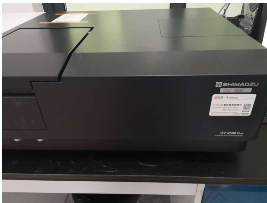
图 6-1 SHIMADZU 紫外可见分光光度计 UV-3600 Plus 图示
