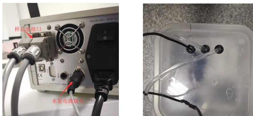
图 6-17 温控样品池安装
