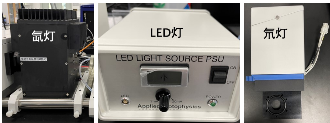
图 6-4 快速反应动力学停流光谱仪光源种类
