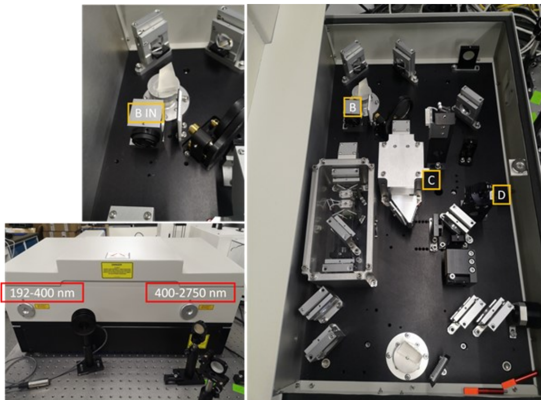
图 7.2. OPO 内部光路图，及波长调节时需要调节的元件位置。
