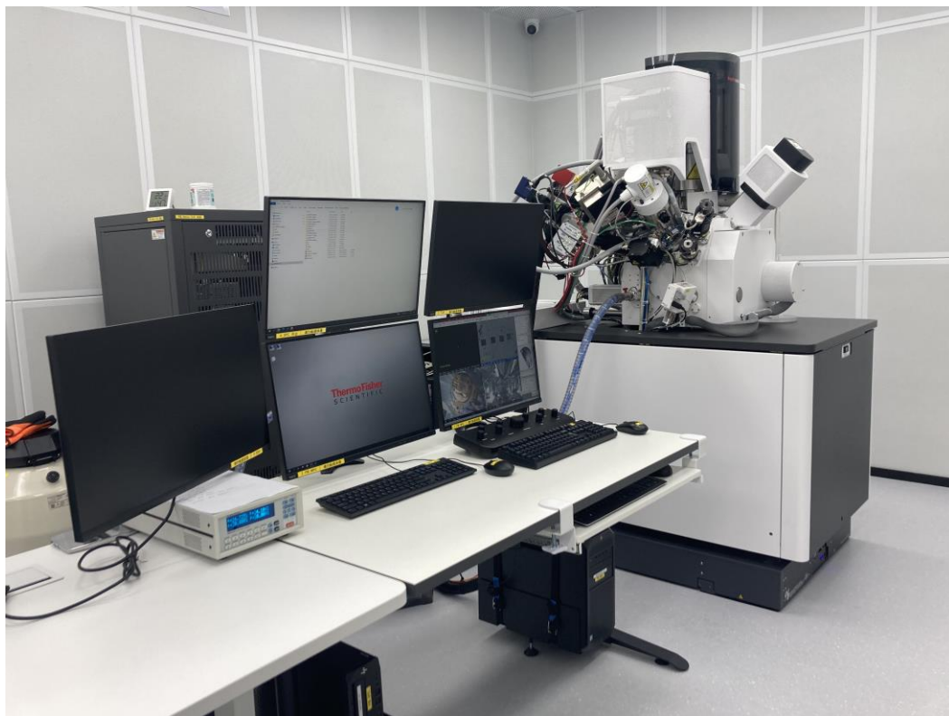
图 6.1-2 双束电镜 Helios 5 UX 系统图示
