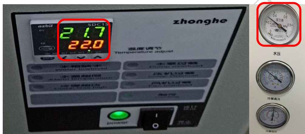
图 6-2 水冷机温度及水压示意图
