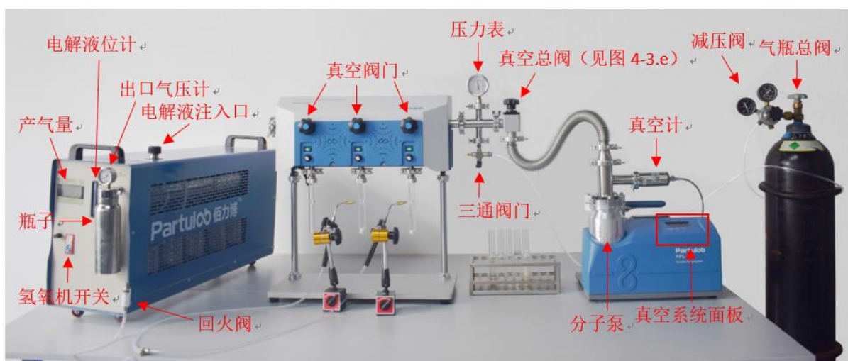
图 4-2 真空自动封管系统分解图示
